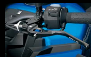
Öntött alumínium kuplungkar (eloxált)
