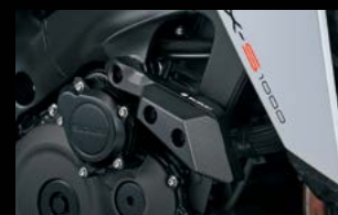
Vázvédő Alumíniumból és ertacetal műanyagból, a sérülések csökkentése érdekében.
