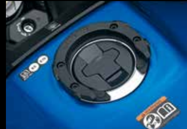
Prsten za učvršćenje torbe na spremnik goriva 99148-00A20-000 Potreban za postavljanje torbe na spremnik.
