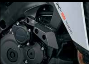
Štitnik za okvir 99114-48K00-000 Pomaže pri smanjenju oštećenja, načinjen od aluminija i polioksimetilena (POM-a).
