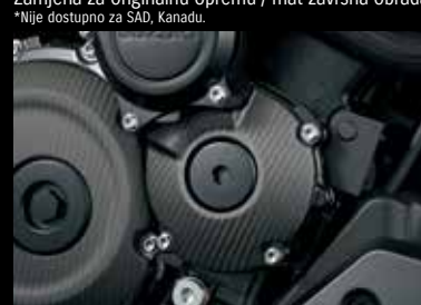
Maska pokretača od ugljičnih vlakana 990D0-04K26-CRB Mat završna obrada. *Nije dostupno za SAD, Kanadu.
