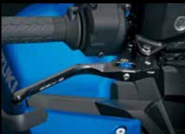
Polužna ručica kočnice (s anodiziranom prevlakom) 99150-48K00-000 Strojno izrađene poluge od aluminija visoke kvalitete. Ukrašene logotipom GSX-s, ove crne poluge s anodiziranom prevlakom naglašavaju sportski izgled motocikla.
