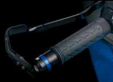
Markolatfűtés 57100-48821-000 Háromféle hőfokbeállítással.
