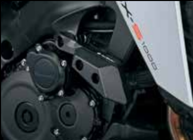
Vázvédő 99114-48K00-000 Csökkenti a sérülések számát, alumíniumból és poliacetálból (POM) készült.
