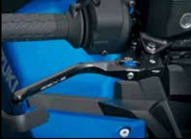
Esztergált fékkar (eloxált) 99150-48K00-000 A csúcsmínőségű tömbalumíniumból megmunkált és GSX-S logóval díszített, fekete eloxált karok fokozzák a motor sportos megjelenését.
