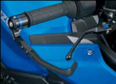
Fékkarvédő 99152-48K00-000 Kiváló minőségű esztergált alumíniumból és tartós műanyagból készült.
