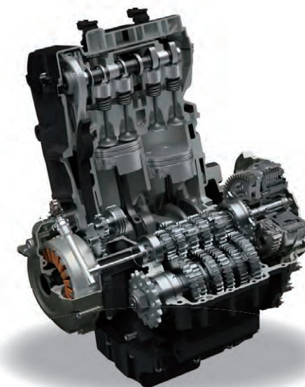
776 cm 3 -es, 4 ütemű, 2 hengeres, folyadékhűtéses, DOHC, soros kialakítású iker-motorblokk.
