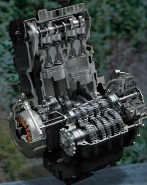
776 cm 3 -es, 4 ütemű, 2 hengeres, folyadékűtéses, DOHC, soros kialakítású motorblokk.
